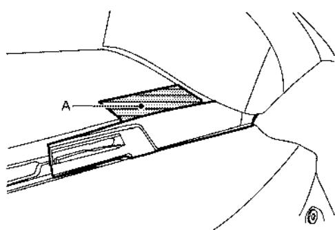
使用拆卸工具(A)分开端盖固定棘爪，然后拆下端盖。
